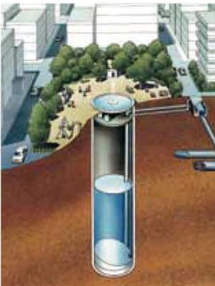
▲ 縦型雨水貯留施設
