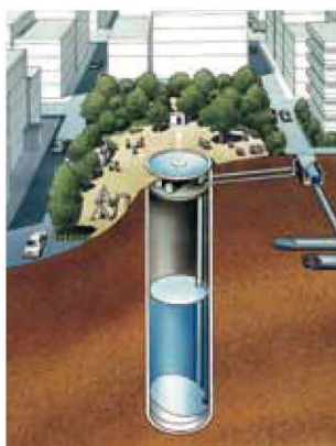
▲ 縦型雨水貯留施設
