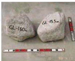
▲玉石の掘削実績 礫径 50~60cm
