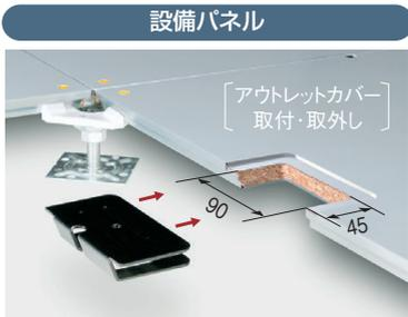
アウトレットカバーは、横から差込み取付けて下さい。取れにくい構造で、カーペット貼替時の紛失を防ぎます。
