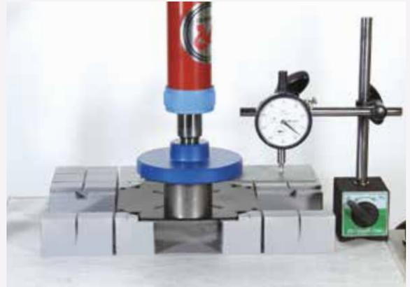
クリープ試験(許容積載荷重)
