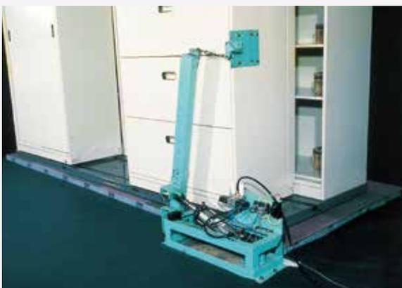
耐振動衝撃荷重試験(横型移動書庫)
