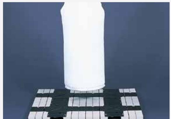
砂袋落下試験(耐衝撃性能) 試験後タイルカーペットを取った状態
