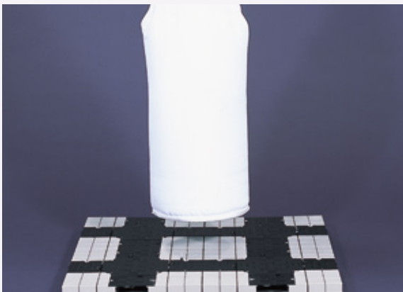
砂袋落下試験(耐衝撃性能) 試験後タイルカーペットを取った状態
