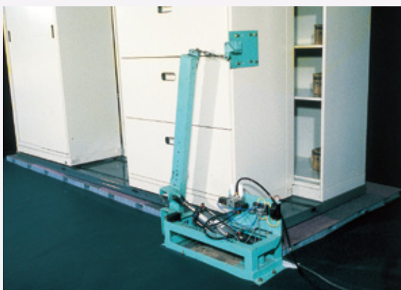
耐振動衝撃荷重試験(横型移動書庫)
