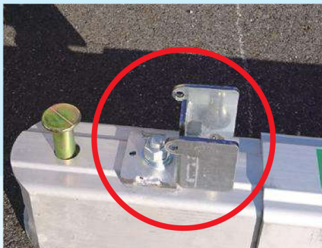
② 組立完了時に下段側になる、水圧四面梁のカプラーガードの蓋を外してください
