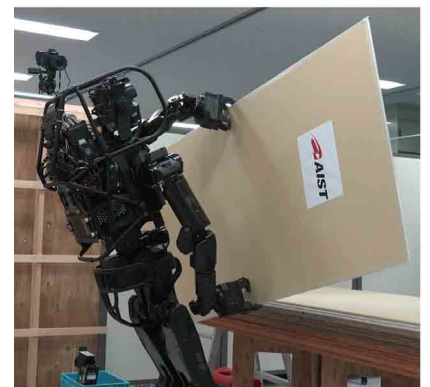
写真-1 HRP-5P による石膏ボードのマニピュレーション
