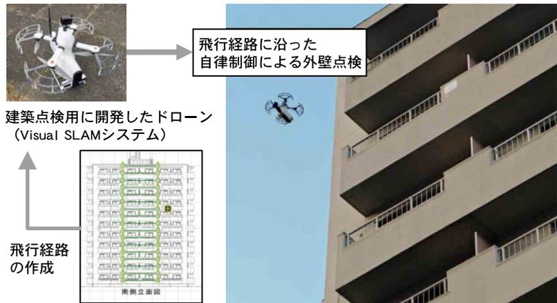
図-5 非GPS環境下でのVisual SLAM型ドローンによる外壁点検の事例
