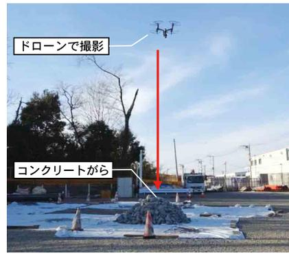
写真-7 ドローンを活用したコンクリートがらの体積計測の状況と結果例
