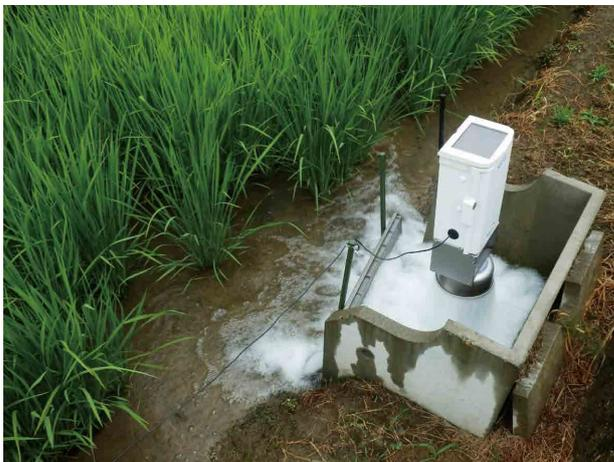
写真-2 遠隔操作型給水栓による灌漑（福井県）
