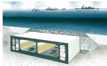
沈埋函の埋戻し
