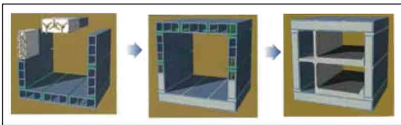
図-6 MMSTの施工ステップイメージ
