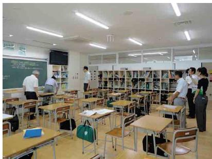
改修により教室と廊下の界壁を廊下側に1m拡張し、ICT機器や机の配置に余裕を持たせている。また、空調設備の導入や窓等の断熱処理により、居住性が大幅に向上している。
