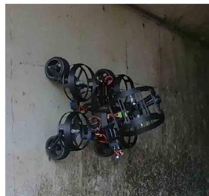
写真－6 壁面を4輪走行するドローン<sup>13)</sup>
