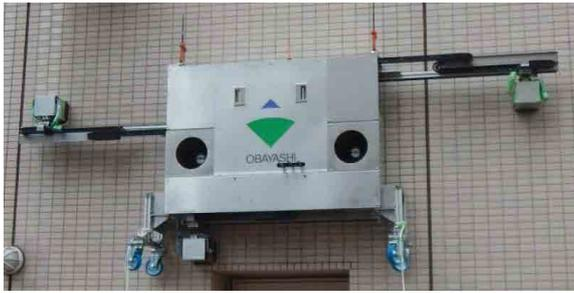
写真-3 調査・点検用ロボット<sup>2)</sup>
