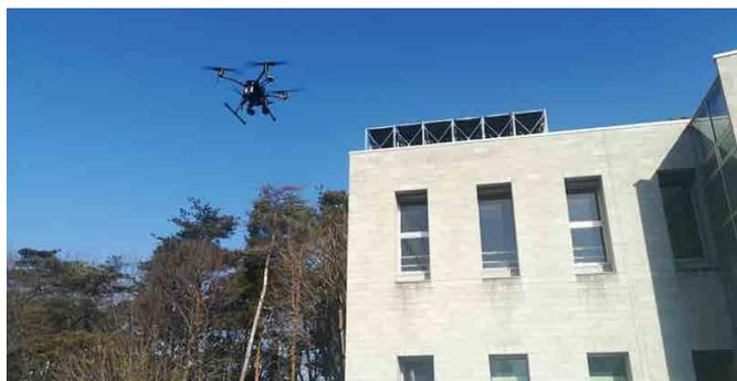
写真-1 赤外線装置を搭載したドローンによる外壁調査の状況
