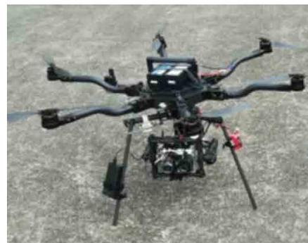
写真-2 赤外線装置を搭載したドローンの一例
