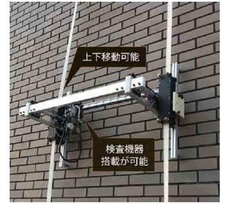
写真-5 調査・点検用ロボット<sup>4)</sup>
