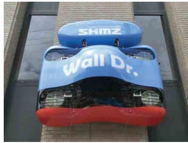
写真-4 調査・点検用ロボット<sup>3)</sup>
