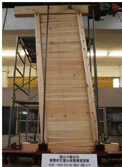
写真ー2 層間変形角1/15rad時の状況
