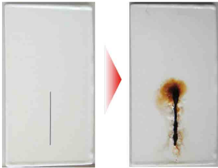
図-4 塗膜のキズから腐食を進展させた試験体の例
