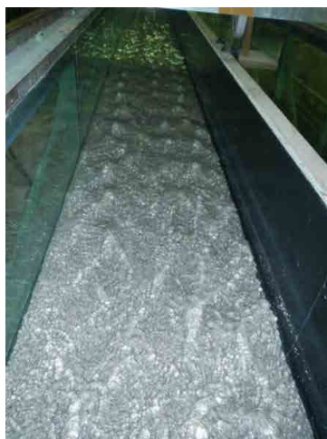
写真-2 実験で観測された三角波(左：中央に1列の波、右：横断方向に3列の波)
