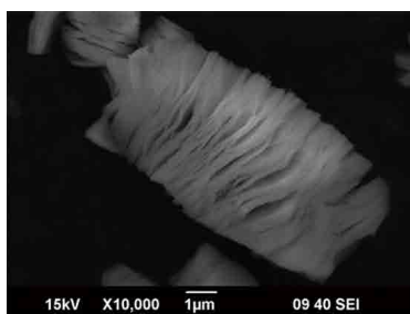
図-7 Ni-Co系LDH結晶粒子とその結晶構造(ただし、結晶構造の層間陰イオンはOH - )
