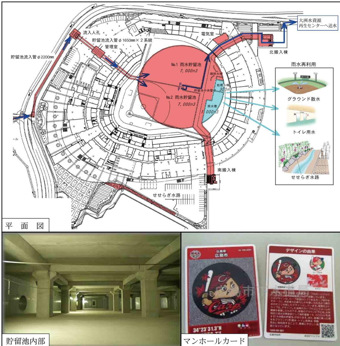
図-2 大州雨水貯留池概要図
