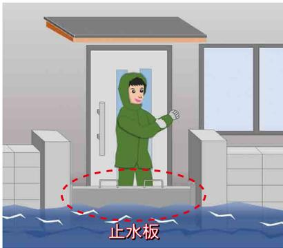
図-3 止水板の設置イメージ
