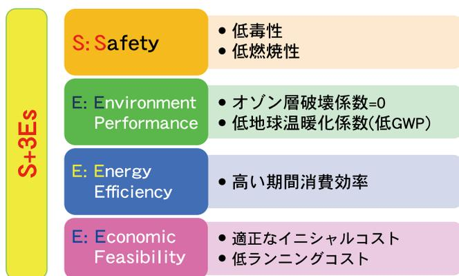
図ー4 冷媒転換における基本コンセプト
