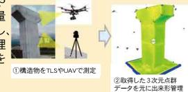
①構造物をTLSやUAVで測定
