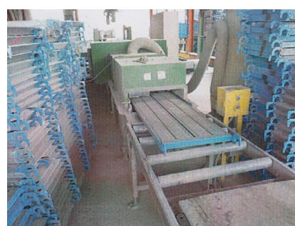
写真-3 床付き布わくのコンクリート等を 除去するケレン（整備作業）
