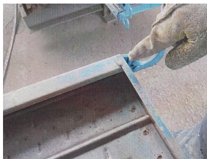
写真-1 床付き布わくの各部の異常の確認 （選別作業）
