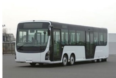
写真-3 実際に試作を行った電動のフルフラットバスの外観
