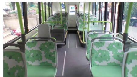
写真-4 実際に試作を行った電動のフルフラットバスの車内
