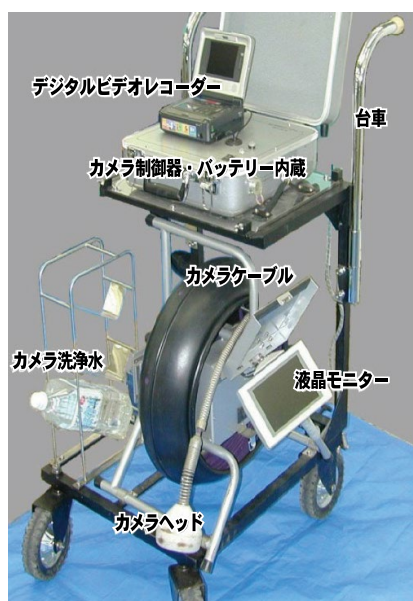
写真－2 簡易テレビカメラ調査機
