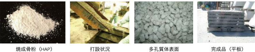
図－1 多孔質体の製作状況
