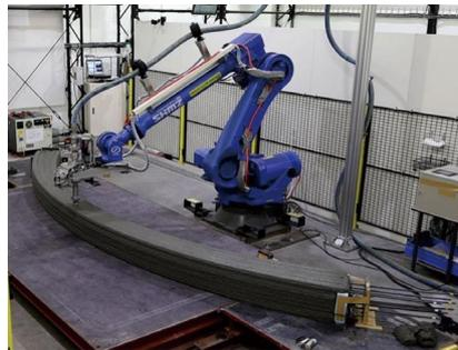
写真-3 ロボット型プリンタによる梁部材の製造
