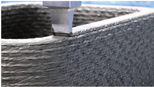
写真-1 材料押出方式の3Dプリンティング
