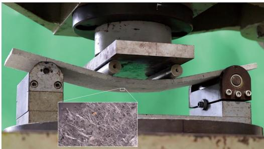
写真-2 ラクツムのたわみ硬化挙動
