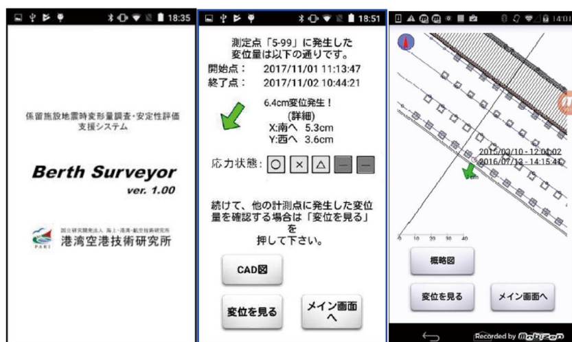
図－6 利用可否判断支援装置（パースサーベイヤー）のアプリ操作イメージ 7)
