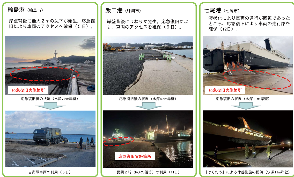
図－2 被災した港湾施設の応急復旧と利用状況
