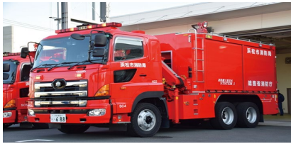
写真-3 海水利用型消防水利システム (スーパーポンパー)
